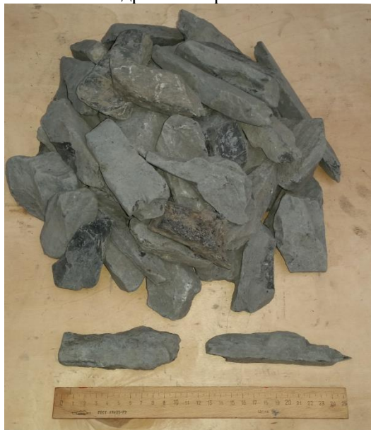
Рис. 4. Щебень до дробления на экспериментальной установке
