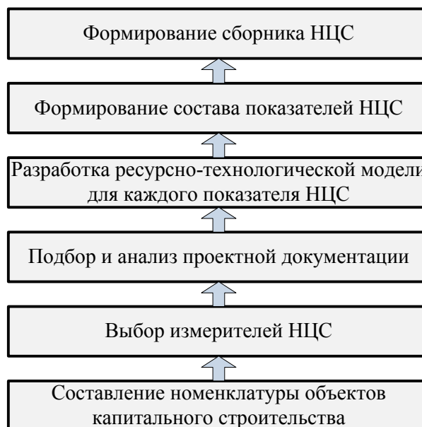
Рис. 1. Общая схема разработки нормативов цены строительства на основе ресурсно-технологических моделей
