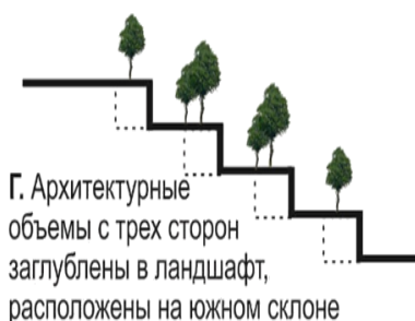
Рис. 2. Приемы интегрирования архитектурных объемов в овражно-балочный ландшафт
