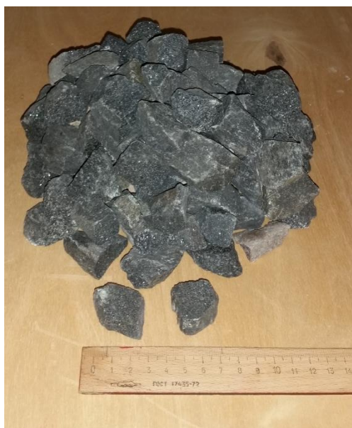
Рис. 5. Щебень после дробления на экспериментальной установке
