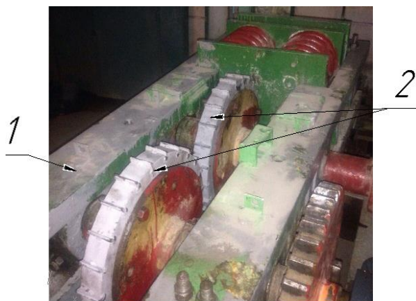
Рис. 2. Зубчатые валки ПВИ
