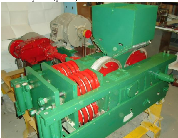
Рис. 1. Экспериментальная установка агрегата для получения кубовидного щебня
